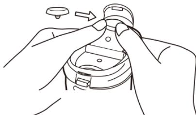
※空気穴パッキンは、押し込みながらパッキンを回すようにして取り付けてください。
