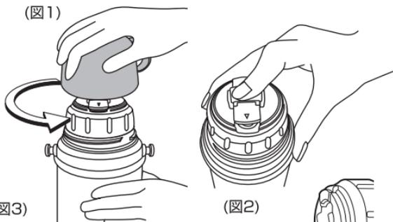
2. フタスイッチを押して、フタを開き(図2)、飲みものをコップに注ぎます。(図3)
