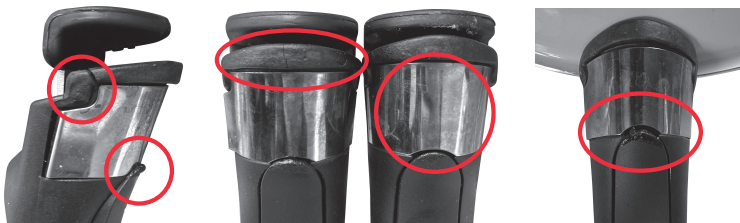
⑪ 脱着ハンドルの焼け、変色、変形（凸凹）、ひび割れ
