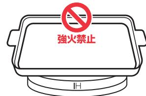
●電磁調理器は電源を入れると急激に加熱するため、少量の油での場合30秒程度で発火点に達します。油で調理をする場合は、油温が上昇しすぎないよう、火力(出力)を「中」以下でご使用ください。
