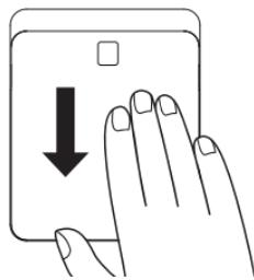
電池を正しく入れたあと、電池カバーを矢印の方向にカチッと音がするまで閉めてください。
