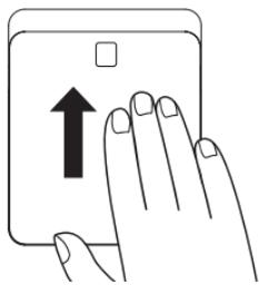
矢印の方向に電池カバーを押し上げてはすします。
