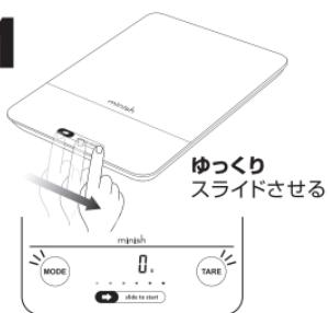
スライドスイッチ部分を左はしから指のはらで右へゆっくりすべらせながら押します。(LEDが6つ点灯したのを確認できれば電源がONになります。)
