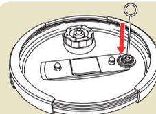
蒸気排出口やロックピン+安全弁が目詰まりしていると、圧力調整が適切に行われず、ふたが飛んだり、内容物がふき出したりして、ケガ・火傷などを負う場合があり、非常に危険です。
