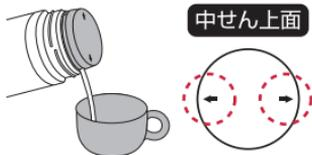
**注** 飲みものを注ぐ際は中せんに刻印された矢印以外の方向に傾けないでください。飲みものが飛散する原因になります。
