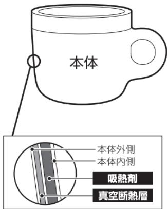
本体はステンレス三層構造で、本体内側と外側の間は真空断熱構造・吸熱剤になっています。
