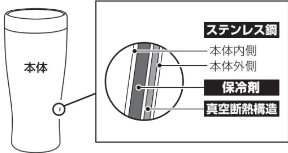
本体はステンレス三層構造で、本体内側と外側の間は真空断熱構造・保冷剤になっています。そのため外気への熱伝導がおさえられ、冷たさを保つことができます。
