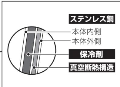
本体はステンレス三層構造で、本体内側と外側の間は真空断熱構造・保冷剤になっています。そのため外気への熱伝導がおさえられ、冷たさを保つことができます。
