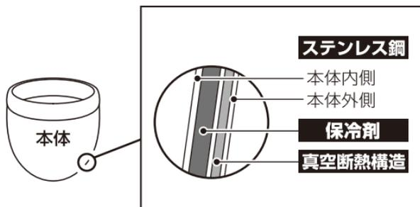
本体はステンレス三層構造で、本体内側と外側の間は真空断熱構造・保冷剤になっています。そのため外気への熱伝導がおさえられ、冷たさを保つことができます。
