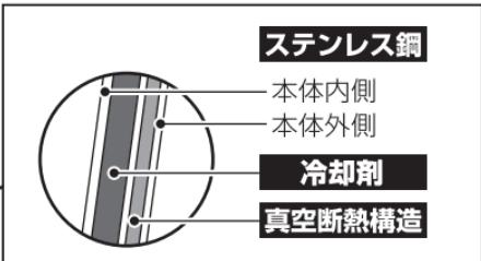
本体はステンレス三層構造で、本体内側と外側の間は真空断熱構造・冷却剤になっています。そのため外気への熱伝導がおさえられ、冷たさを保つことができます。
