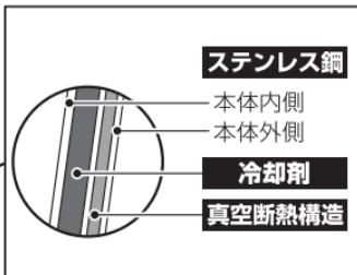
本体はステンレス三層構造で、本体内側と外側の間は真空断熱構造・冷却剤になっています。そのため外気への熱伝導がおさえられ、冷たさを保つことができます。
