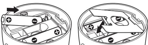
3. 乾電池カバーを取りはずしたときと逆の手順で取り付けてください。
