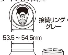
接続リング・グレーは、缶上部の直径53.5～54.5mmの缶に対応します。
