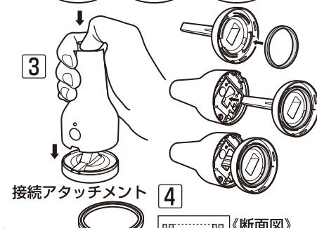
パッキンの凹みを接続アタッチメントの底面の凸部に取り付けてください。
