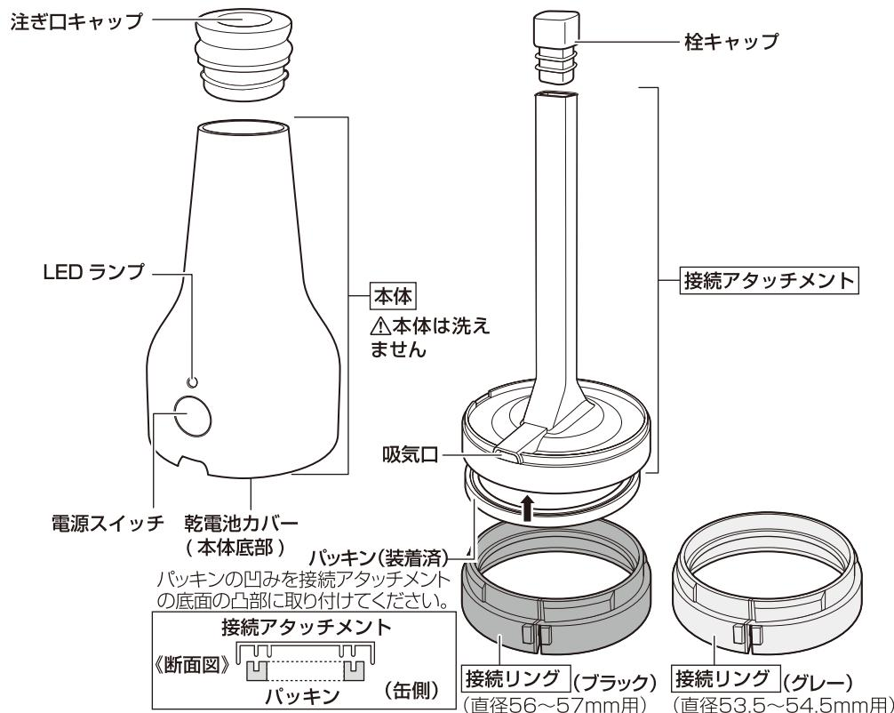
①本体の電源スイッチ下の凹みと接続アタッチメントにある吸気口を合わせるように矢印の方向に差し込みます。
