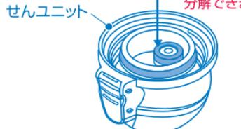
上下の方向を確認し、せんユニットに正しく取り付けてください。
